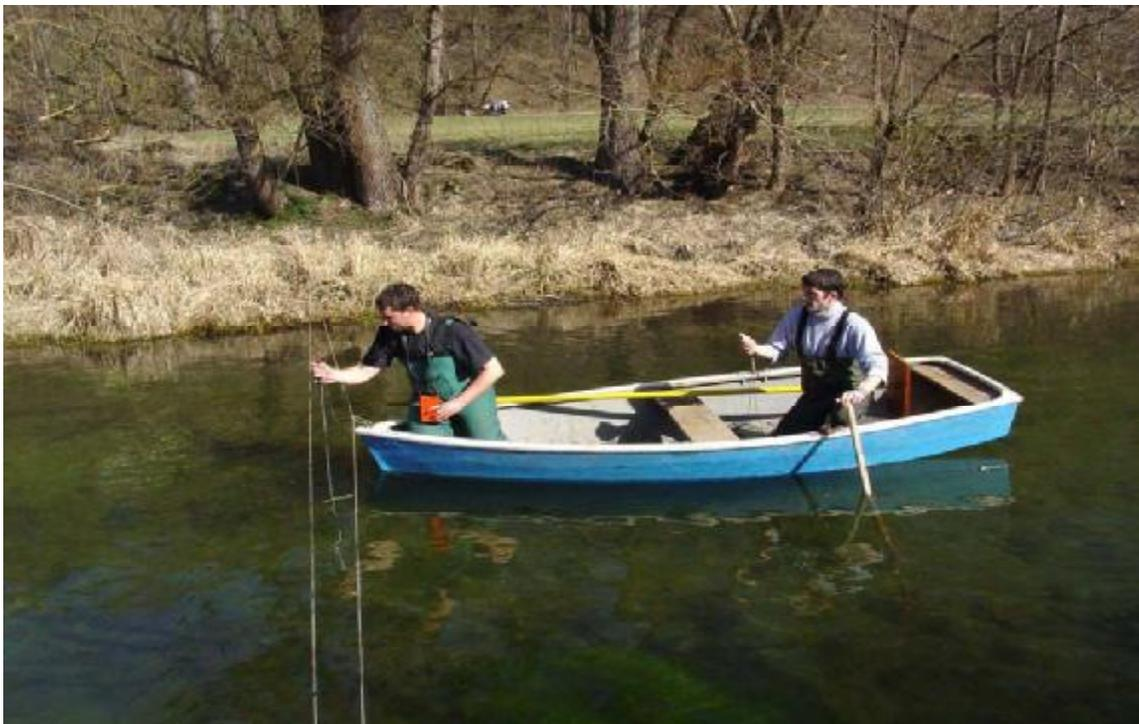
Abb. 4: Messung der Strömungsgeschwindigkeit an einem Transekt
