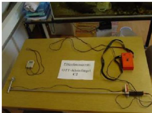
Abb. 6: Flügelmessgerät
